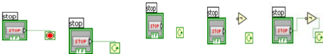
Fig.6. Secuencia de paso de "Stop if true" a "Continue if true" de While Loop. (Fuente Labview).
