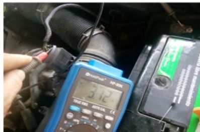
Prueba de aceleración brusca hasta 3500RPM
