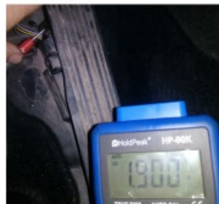
Valor voltaje sensor 2 pisado a fondo
