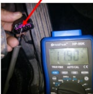
Alimentación sensor 1 (pin 3)
