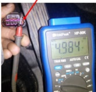
Alimentación sensor 1 (pin 1)
