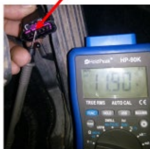
Alimentación sensor 2 (pin 4)
