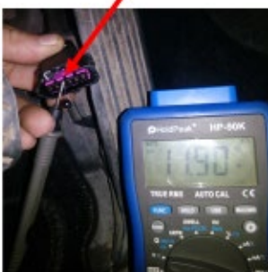
Alimentación sensor 1 (pin 3)
