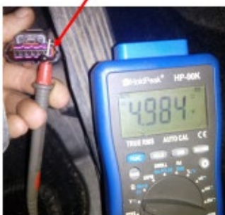
Alimentación sensor 1 (pin 1)
