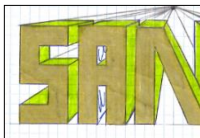
Figura 7. Típico error en el dibujo de la perspectiva cónica.
