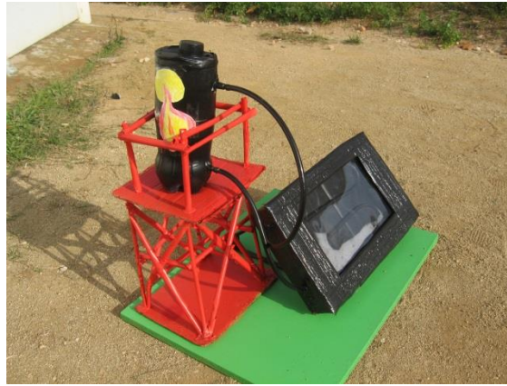
Ilustración 8: Termo solar en marcha. Fuente: Ximo Montaner
