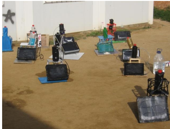
Ilustración 9: Termos solares. Fuente (Ximo Montaner)
