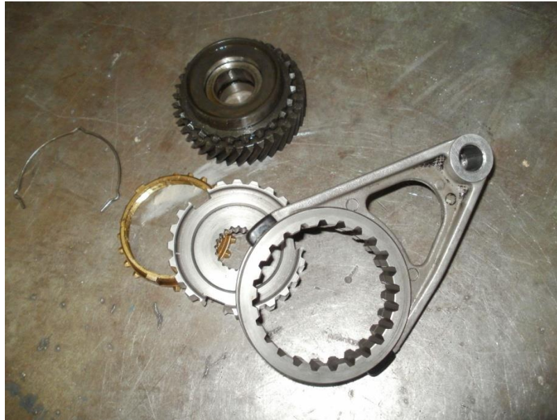
Horquilla, conjunto de sincronizador y piñón de 5ª velocidad
