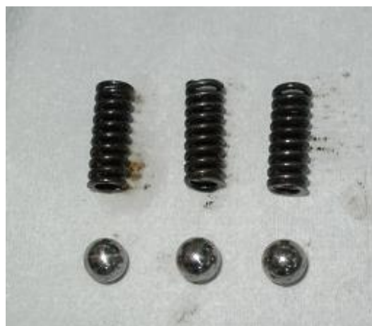
Bolas y muelles del mecanismo de enclavamiento de velocidades
