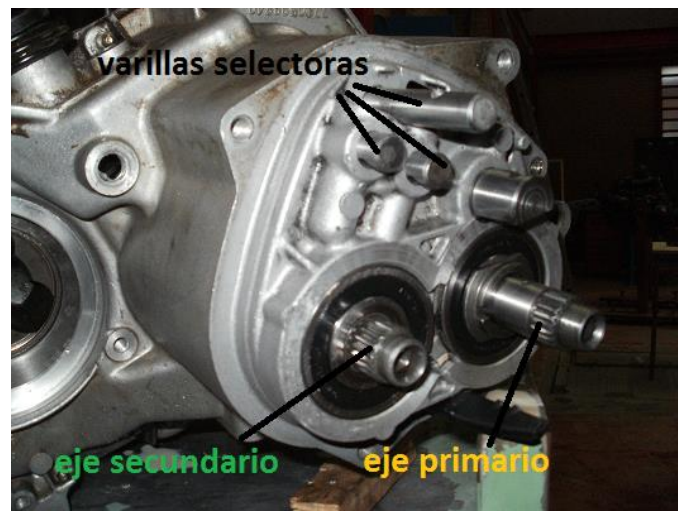
Lateral de la caja con piñones de 5ª, horquilla y sincronizador desmontados
