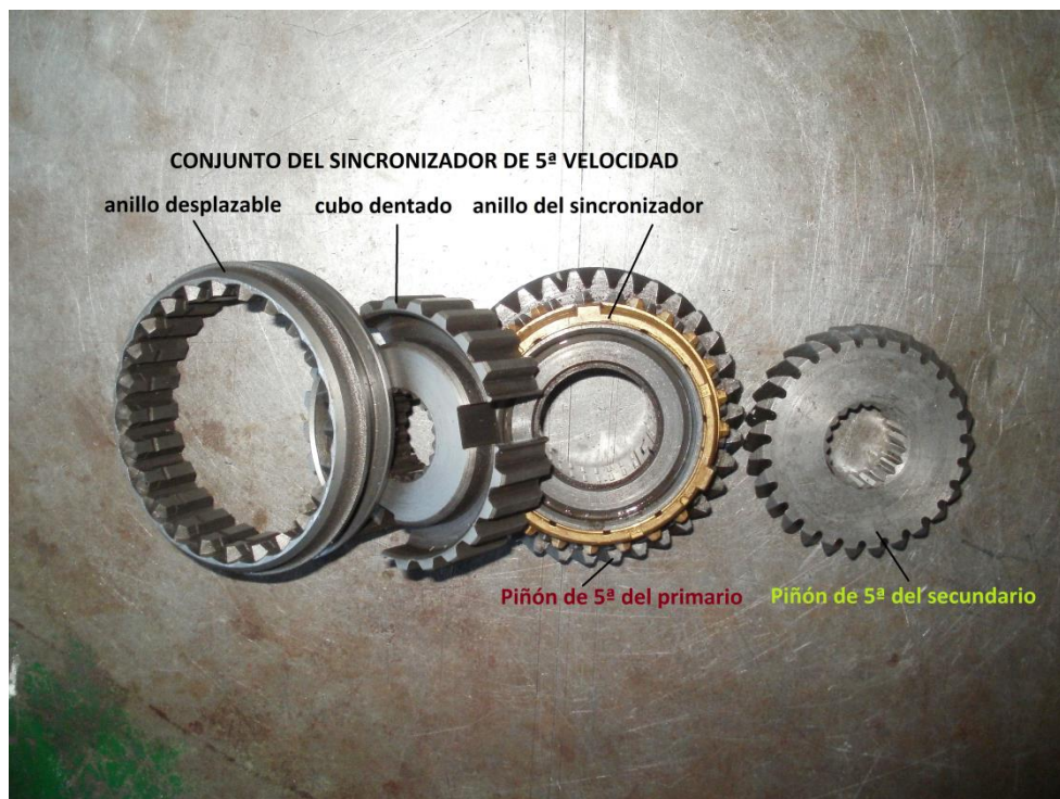
Conjunto de sincronizador de 5ª y piñones de esa velocidad (6)
