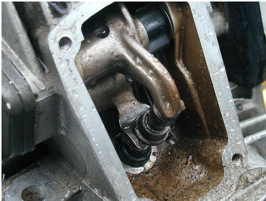
Balancines de cierre y apertura acoplados en válvula del sistema DESMO
